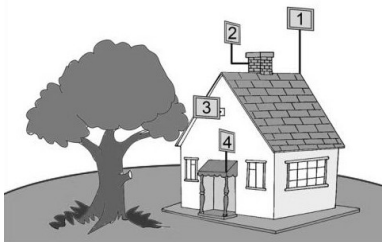
Рисунок 1 – Варианты установки антенны
