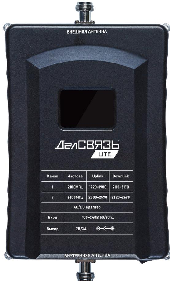
Рис. 13 Внешний вид усилителя DS-LT-2100/2600-23
