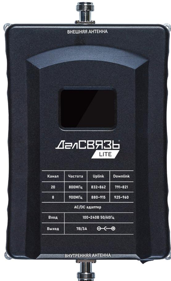
Рис. 8 Внешний вид усилителя DS-LT-800/900-23
