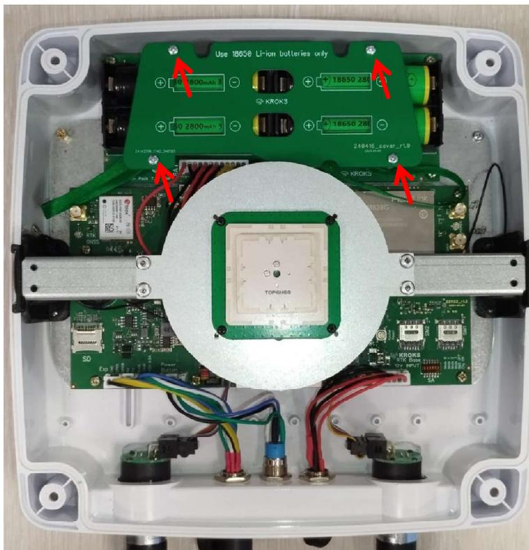
Для извлечения АКБ потяните хлыстик вверх и извлеките АКБ. При Установке АКБ подложите хлыстик под пару аккумуляторов для последующего безопасного их извлечения.
