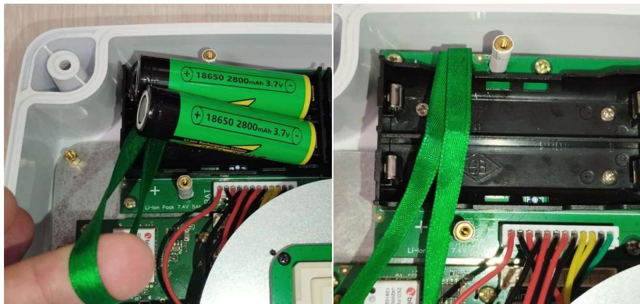
Установите новые АКБ 18650 (4шт) **строго** соблюдая полярность, указанную на черном держателе АКБ и продублированную информацию на печатной плате и прижиме. Все АКБ устанавливаются одинаково + полярностью в одну сторону. При неправильной установке АКБ прозвучит предупреждающий звуковой сигнал и нужно срочно извлечь его и установить правильно. Напряжение АКБ должно быть в диапазоне 3.3-4.2В с разницей между аккумуляторами не более 0.2В.
