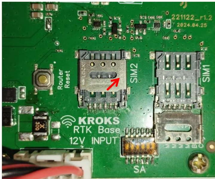
Установите nano-sim карту металлическими контактами в сторону платы (от себя) скошенным углом как на лотке для карты. Закройте крышку лотка и потяните в направлении стрелки LOCK. Закрутите верхнюю крышку устройства.
