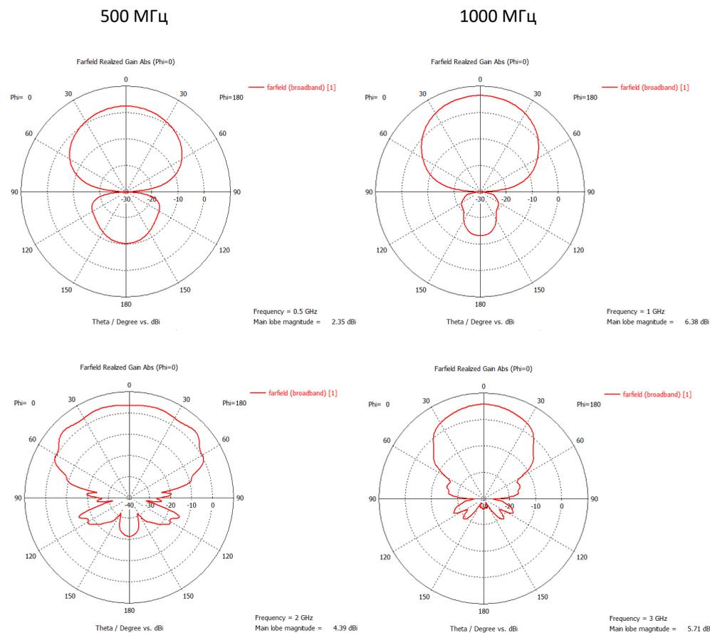
Коэффициент усиления антенны в рабочем диапазоне частот
