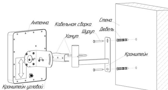
Рисунок 2 – Монтаж антенны
