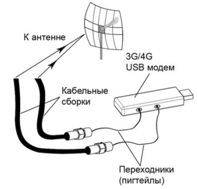
Пример подключения 3G/4G USB модема
