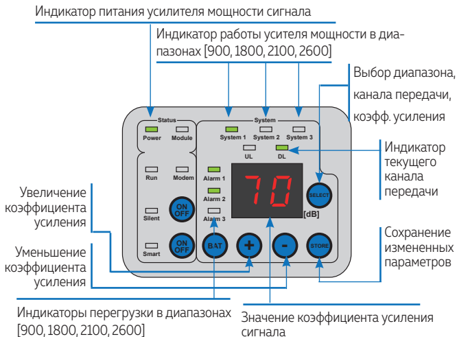
Рисунок 5 - элементы панели управления усилителя мощности сигнала
