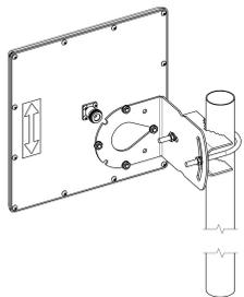
Рисунок 3 – Монтаж антенны на мачте
