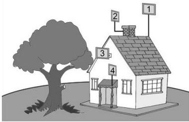
Рисунок 1 – Варианты установки антенны
