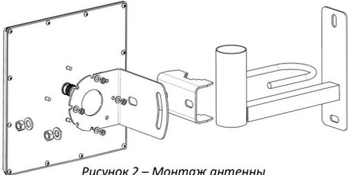
Рисунок 2 – Монтаж антенны
